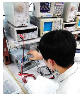
右:ファンクションジェネレータで周波数を設定する様子
